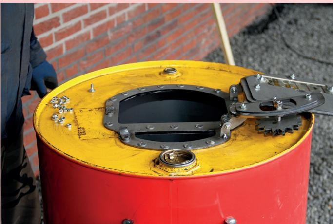
Setzen Sie nun das Türelement auf die Vorderseite des Fasses und befestigen Sie es zusammen mit der Rückplatte im Fass, indem Sie alle Schrauben und Muttern einsetzen.
