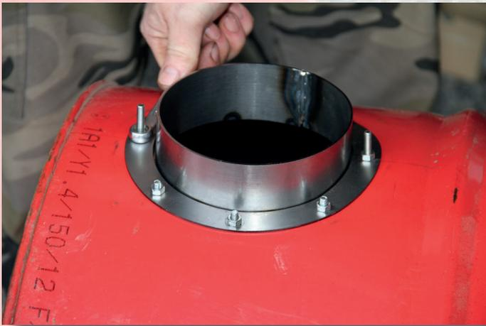
Setzen Sie die Innenplatte und den Ring in das Loch für den Kamin ein und befestigen Sie dies mit den langen Schrauben in der „Spitze“ des Fasses. Auf diese Weise ziehen Sie die Innenplatte, das Fass und den oberen Ring zusammen.
