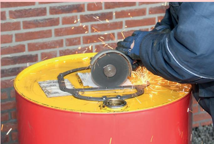
Markieren Sie die Innenseite des Dichtrings und entfernen Sie die markierten Teile mit einem Winkelschleifer...
