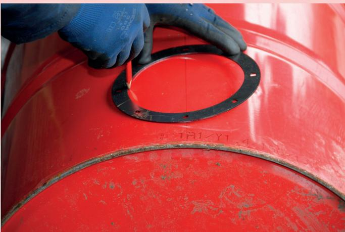
Setzen Sie das Fass auf die Vorderbeine und markieren Sie das Loch und die Befestigungslöcher des Kamins auf der Rückseite des Fasses.
