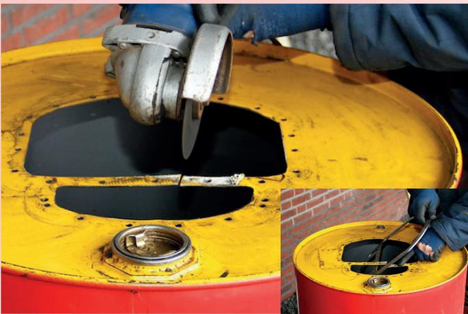
Da der Dichtring nicht durch die Löcher passt, schleifen oder sägen Sie das Zwischenstück zwischen den beiden Löchern und entfernen es.
